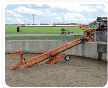
貯留槽 (スラリーストア、ラグーン) 固液分離後に出てきた分離液を貯蔵する槽です。 ・ラグーンポンプ ・PTO バーチカルポンプ
