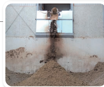
固液分離棟 消化液を個体と液体に分けるための設備で、固形物は肥料として、液体は液肥として使用されます。
